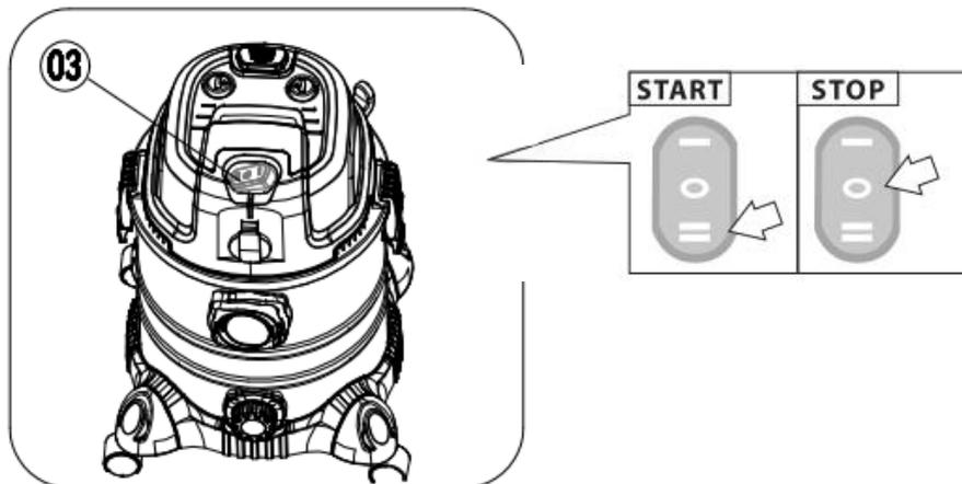
Posizione I: l'elettrotensile e l'aspirapolvere si attivano
